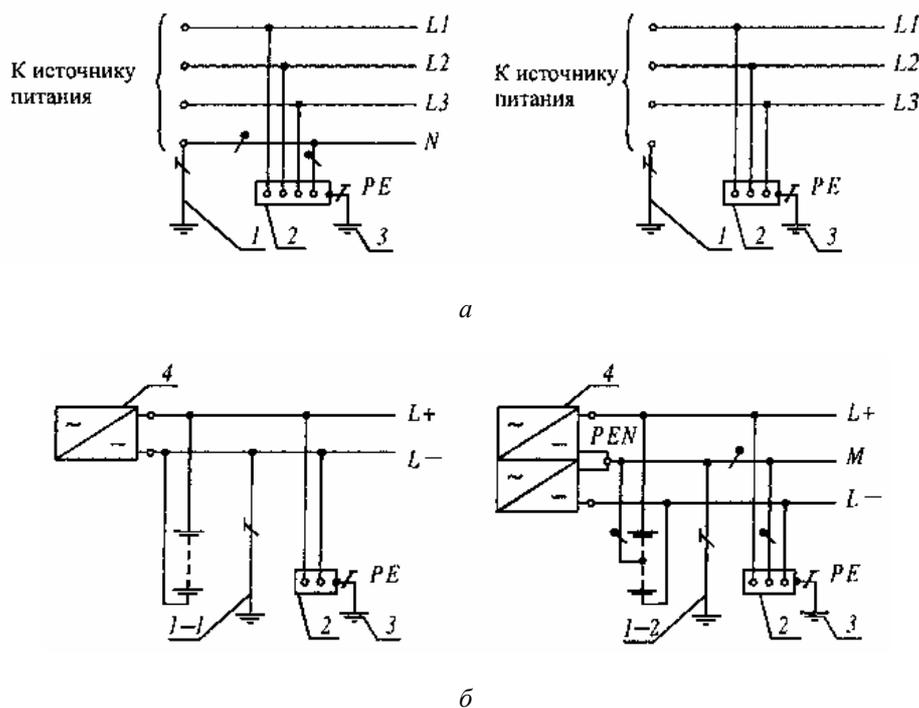
Рис. 1.7.5. Система *TT* переменного (а) и постоянного (б) тока. Открытые проводящие части электроустановки заземлены при помощи заземления, электрически независимого от заземлителя нейтрали: *1* - заземлитель нейтрали источника переменного тока; *1-1* - заземлитель вывода источника постоянного тока; *1-2* — заземлитель средней точки источника постоянного тока; *2* - открытые проводящие части; *3* - заземлитель открытых проводящих частей электроустановки; *4* - источник питания
