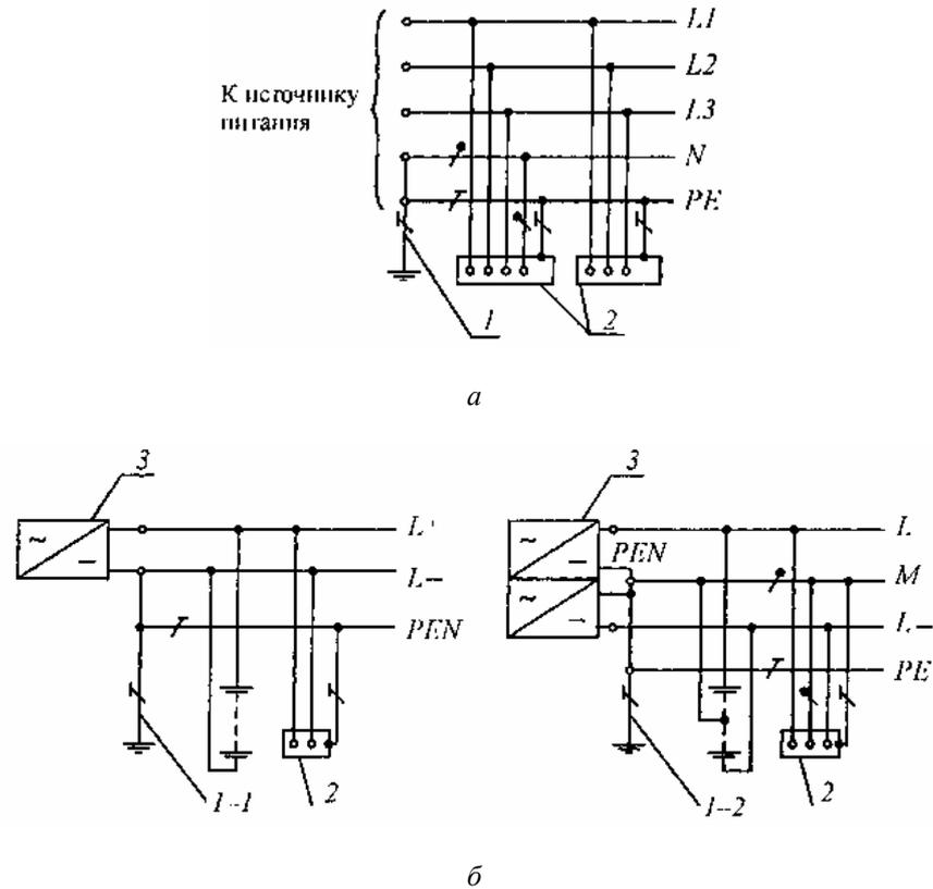
Рис. 1.7.2. Система *TN—S* переменного (*a*) и постоянного (*б*) тока. Нулевой защитный и нулевой рабочий проводники разделены:
