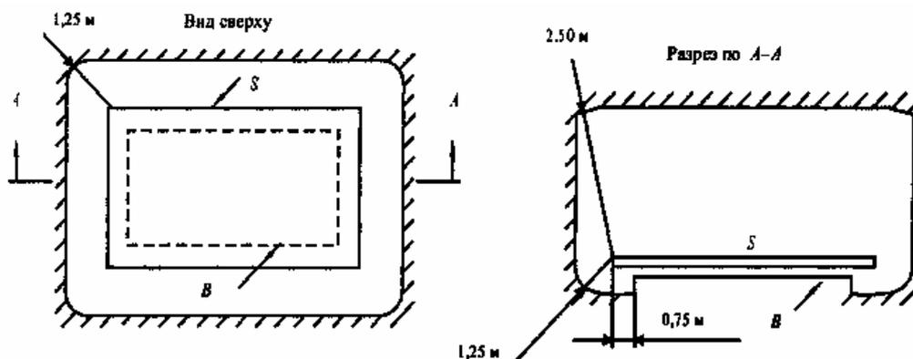
Рис. 1.7.6. Зона досягаемости в электроустановках до 1 кВ:
